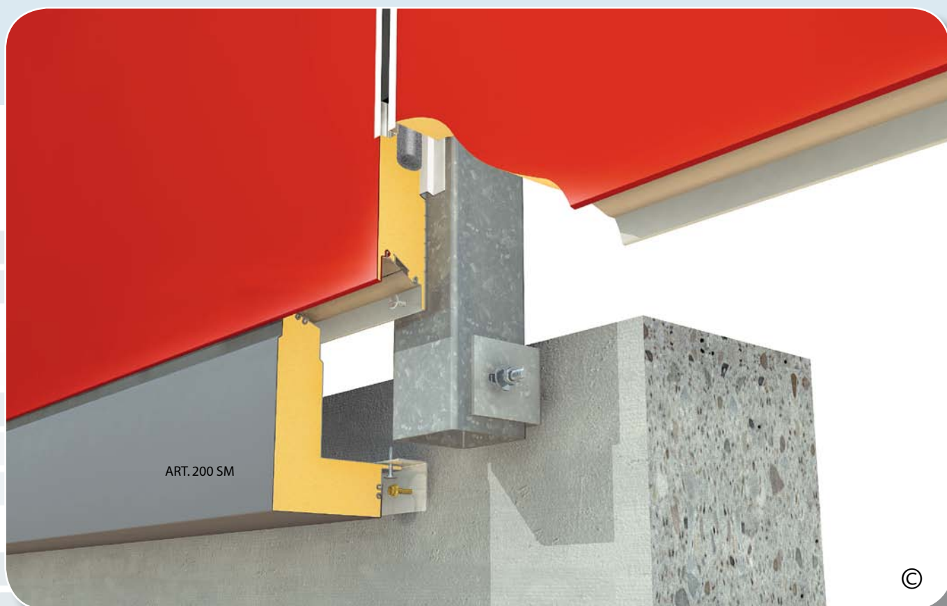
CORONAMENTO INFERIORE ANGOLO 90° FOAMED 90° BOTTOM CONNECTION
